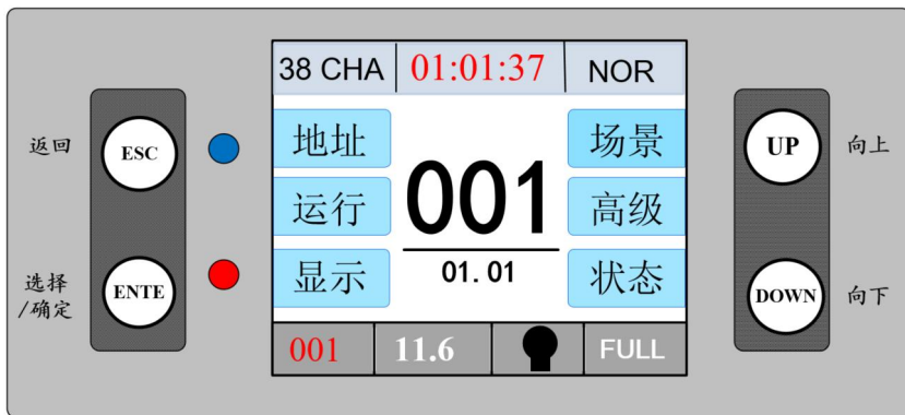
图 3 触摸按键显示面板示意图
