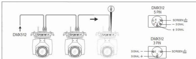
图 1 DMX 信号线连接示意图
