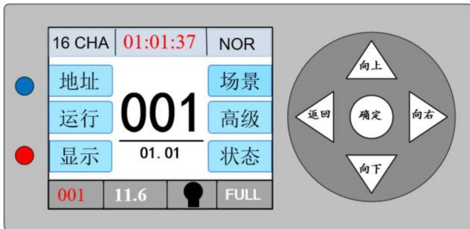
图 3-1 五键显示面板示意图
